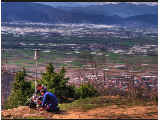
“Направена е редовна проверка на опремата за мониторинг на прашината за да се осигури дека опремата работи непречено” - Драги Пелтечки, рударски инженер
