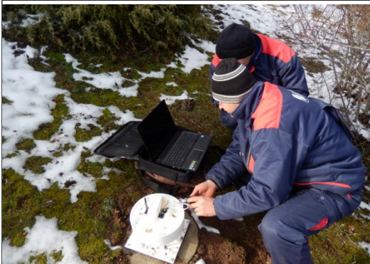
„Мерачите со внатрешни запишувачи на податоци се поставени за собирање податоци за врнежите на одредени точки во близина на нашата проектна локација“ – Драги Пелтечки, рударски инженер
